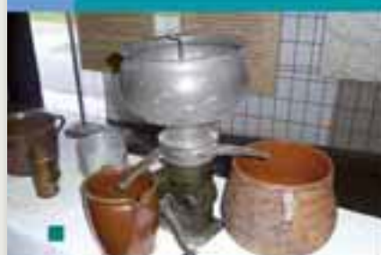
■ Strumento per dividere il latte dalla panna Archivio Fotografico Staranzano
